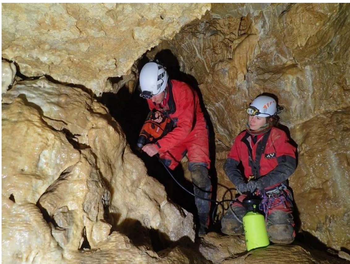
Coring a speleothem para sa paleoclimate research, na isinagawa sa ilalim ng permit sa isang Site of Special Scientific Interest sa UK. Larawan ni John Gunn.
