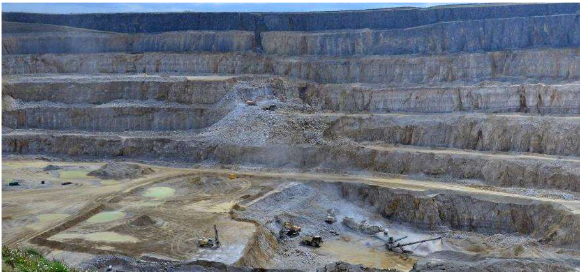
英国Peak DistrictにあるDowlow石灰岩採石場。この採石場の面積は約0.5km 2 で、2021年の最低地点は元の地表から約100m低かったが、導水路や洞窟は遮断されておらず、採石面からの地下水の流入はない。写真：Tony Marsden.
