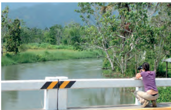
Figure 8 : Jaugeage du Rio Negro par pistolet radar
