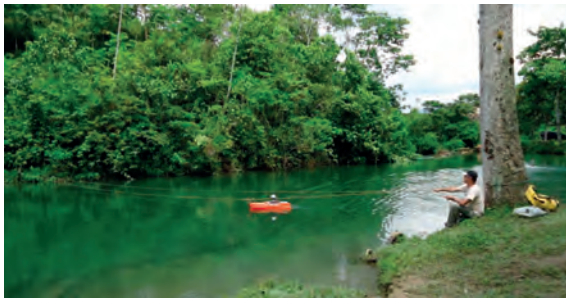
Figure 7 : Jaugeage du Rio Aguas Claras par ADCP
