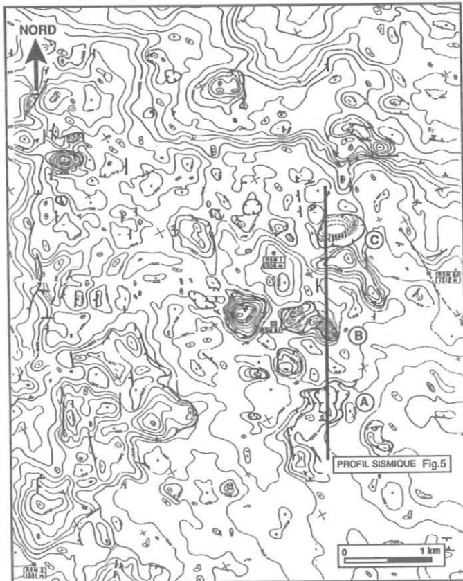
Fig.4 Morphologie du toit du paléokarst de Rospo Mare déduite de l'interprétation de la sismique marine
