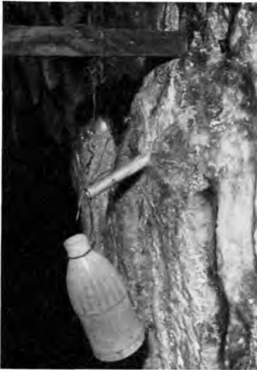
Abb. 3. Aus dem Inneren der Wülste am Scheitel der Säule »Okajeni steber« zapft ein Metallrohr ständig das zur Analyse nötige Wasser. — Fig. 3: A metallic pipe on the top of the column »Okajeni steber« conducted water out of the dripstone steadily needed for analyses.
