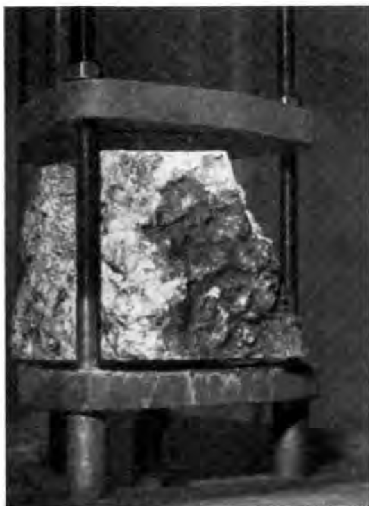
Abb. 1. Prüfung der Durchlässigkeit einer Stalagmitmasse aus dem Eingang der Grotte von Postojna im Laboratorium bei Wasserdruck von 2 atm (von unten). — Fig. 1: Testing the water permeability of a stalagmite mass from the entrance in the Postojna Cave in the laboratory at a pressure of 2 atm (from below).
