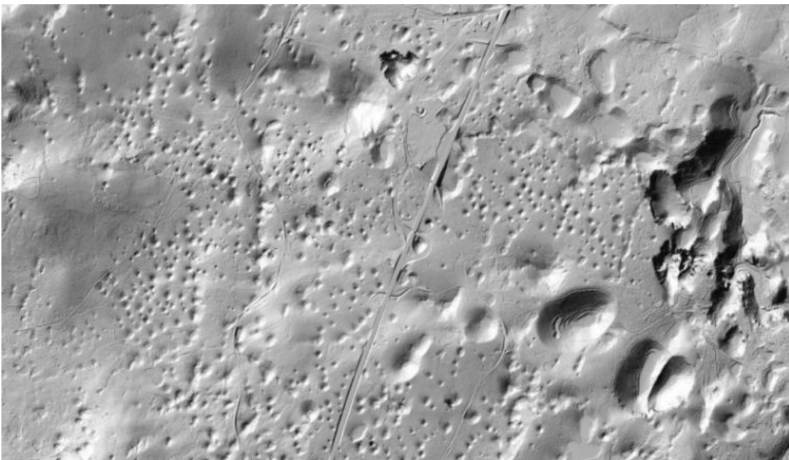
Imagens aéreas (superiores) e LIDAR (inferiores) de dolinas adjacentes a uma grande rodovia perto de Divaca, na Eslovênia. Reproduzido do Atlas do Meio Ambiente, Agência Ambiental da República da Eslovênia (EARS).
