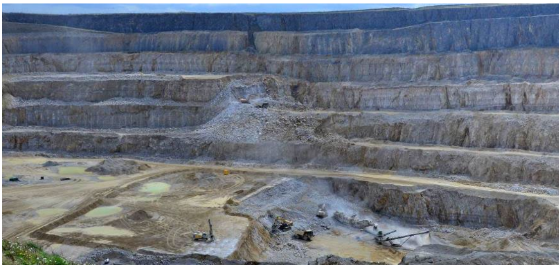
Cariera de calcar Dowlow din districtul Peak, Marea Britanie. Cariera are o suprafață de cca. 0,5 km 2 iar în 2021 nivelul inferior se afla la aproximativ 100 m sub suprafața terenului inițial fără să intercepteze galerii sau peșteri; nu există apă subterană la suprafața carierei. Foto Tony Marsden.
