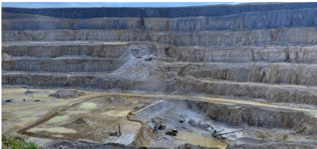
Известняковый карьер Даулоу (Dowlow) в Ликовом Районе, Великобритания. Площадь карьера около 0.5 km 2 , и в 2021 г. самая низкая точка располагалась примерно на 100 м ниже оригинальной поверхности земли, но никакие каналы или пещеры не были вскрыты, и не было никакого притока грунтовых вод со стен карьера. Фото Тони Марсден (Tony Marsden).
